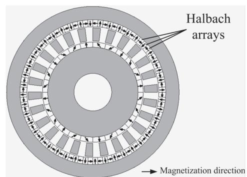
**Fig. 4** Halbach magnetic gear
