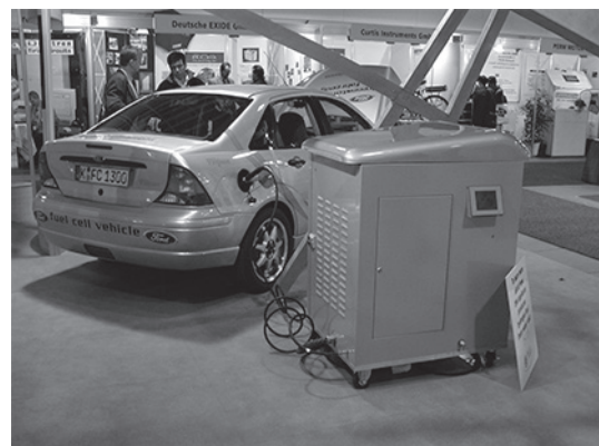
図9：一つの小型ユニットに電解装置とコンプレッサーを入れた10年前の水素発生器の写真(Stuart Energy Systems社)
