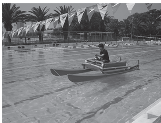
図13：大阪観光船設計のために試作した水素ボンベ搭載燃料電池船の例
