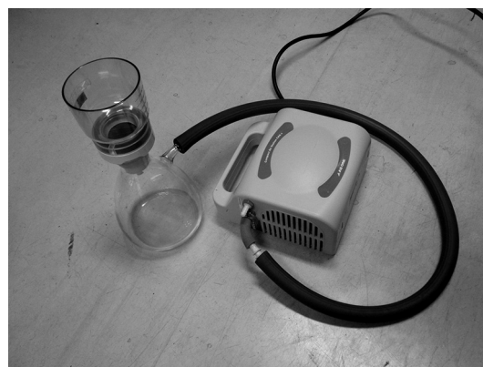
図1: 考案した大気浮遊物質捕集装置
