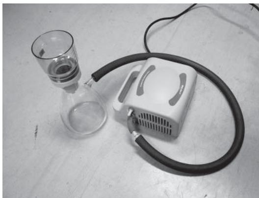
図1：考案した大気浮遊物質捕集装置
