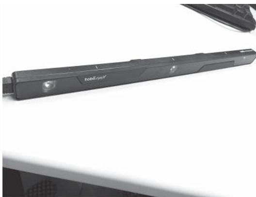
図7：トビーテクノロジー社製視線計測装置
