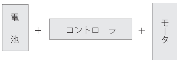
図5：電気自動車駆動部の構成は簡単であり、部品が世界中で容易に手に入る市場特性をもつ。
