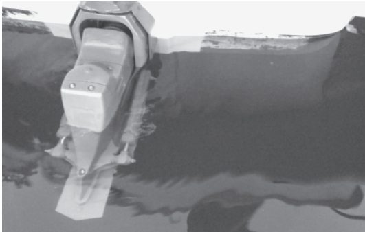
図8：船の艫に取り付けたスターンドライブとエンジン用プロペラの写真
