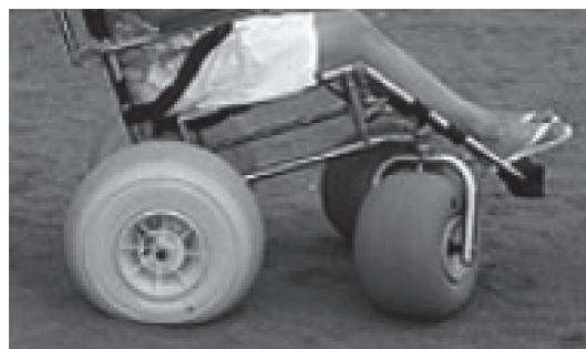
図3: 低圧タイヤを搭載した走行系(車イス)(MsWing)
