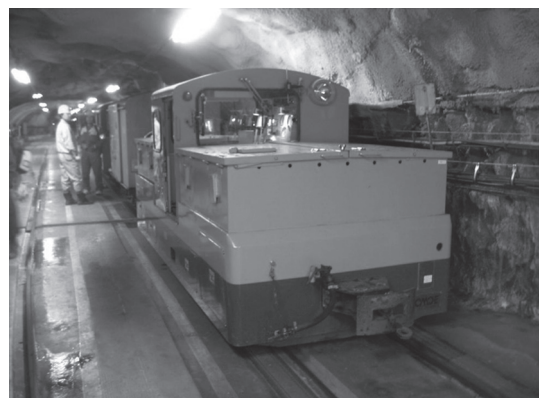
図5：黒部溪谷を走る電池式車両（202 V, 30 kW 電動モータ使用）
