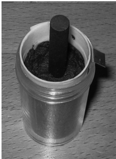
図7：合剤充填後の電池
