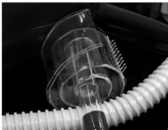
図2：吸引式ヘアドライヤーの写真
