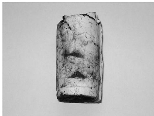
図12：ワットマン3濾紙の2箇所の破損
