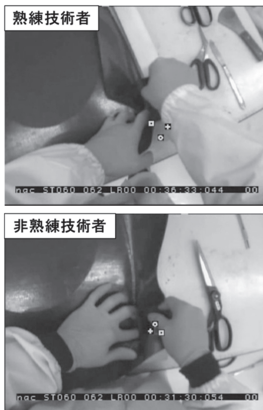
図6：1層目のコーナー積層の様子
