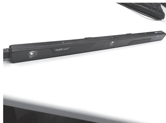
図7：トビーテクノロジー社製視線計測装置
