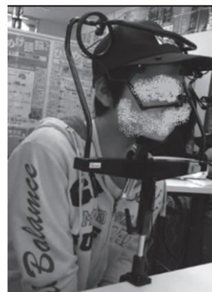
図3：頭部固定装置と実験の様子
